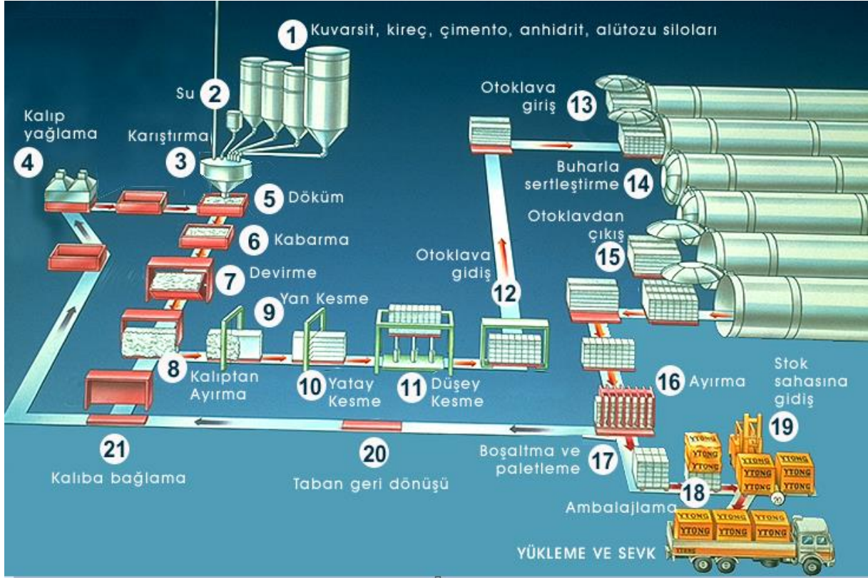
Şekil 1: Ytong Gazbeton Blok Üretimi Akış Şeması
